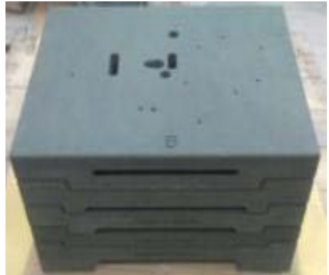
Изготовленные песчаные стержни литейной формы на установке
