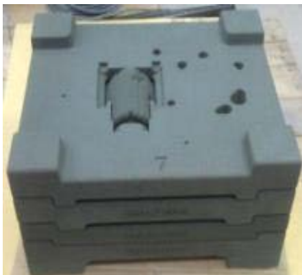
Изготовленные песчаные стержни литейной формы на установке
